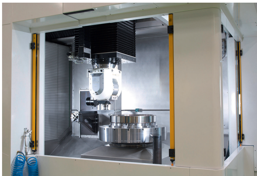
1 Die MikroTurnGrind Vertical von Hembrug im Schleifmodus © Danobat
